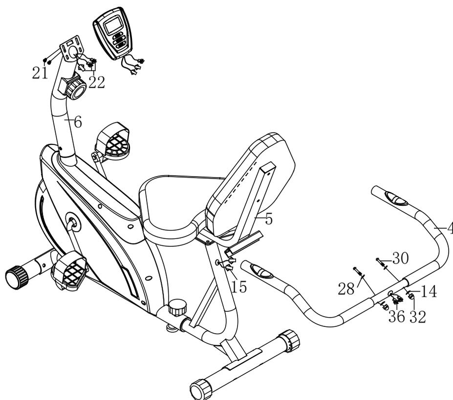
**A. Instalación del manillar y la computadora**
