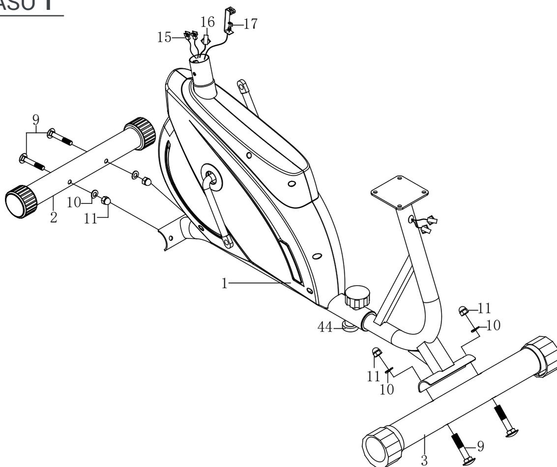
**A. Instalación de los estabilizadores delantero y trasero.**
