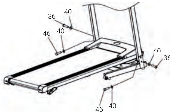
Levante el caño vertical izquierdo y el caño vertical derecho como se muestra en el dibujo de la izquierda.
