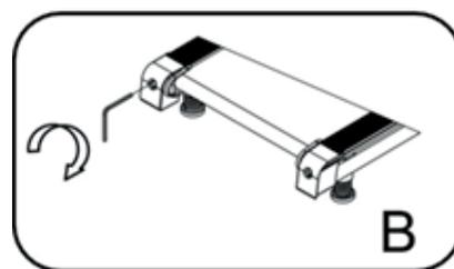
3. Ajuste el cinturón después de un período de tiempo de uso. Saque el interruptor, gire el perno de ajuste izquierdo y derecho 1/4 en el sentido de las agujas del reloj, luego vuelva a comenzar a correr para verificar el ajuste del cinturón hasta que el cinturón esté bien ajustado. IMAGEN - C
