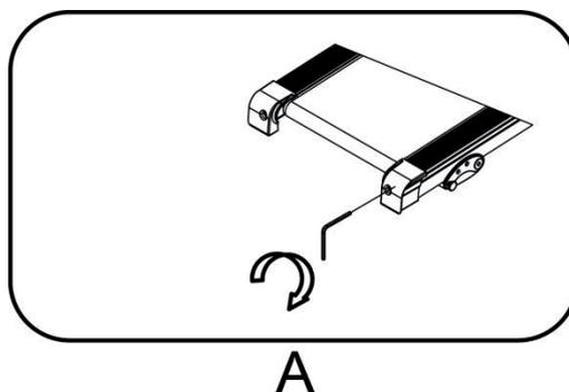
Si la correa tiende a moverse hacia la izquierda, gire el tornillo de ajuste de la correa a la izquierda en el sentido de las agujas del reloj 1/4 de vuelta. Si la correa permanece inclinada hacia la izquierda, gire el tornillo de ajuste de la correa a la derecha en dirección contraria a las agujas del reloj 1/4 de vuelta, como se muestra en la imagen B.
