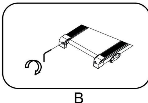
Después de haber sido utilizado durante un tiempo, el cinturón puede alargarse ligeramente y puede aparecer un deslizamiento y una detención cuando una persona corre sobre él. Cuando aparezcan estos fenómenos, debe asegurar los tornillos en ambos lados 1/4 de vuelta. Si la correa está demasiado apretada, simplemente afloje el tornillo en ambos lados 1/4 de vuelta, como se muestra en la imagen C.
